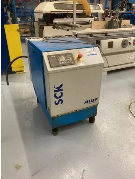
Description d'un compresseur : Le compresseur fait partie intégrante d'un atelier de menuiserie, charpente ou ébénisterie ou autres usinages. Les opérateurs en ont besoin pour certains nettoyages et de plus en plus les machines pour le travail du bois ont des déplacements pneumatiques. Le compresseurs peut être simple, à pistons ou pour avoir de plus grandes capacités, à vis avec assécheurs d'air pour évacuer toute l'eau avant l'arrivé de l'air aux machines.
