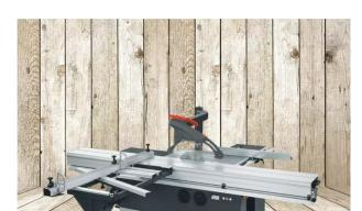
Réglage de la hauteur et de l'inclinaison manuel 0 - 46° de la lame de scie avec affichage numérique Puissance d'entraînement 4 kW, avec 4 200 t/min Chariot à doubles rouleaux, longueur du chariot 3 200 mm Butée parallèle avec réglage fin manuel, largeur de coupe 1 000 mm Butée d'onglet angulaire, découpage en longueur jusqu'à 3 450 mm Préparation pour le montage ultérieure d'un groupe d'inciseur Diamètre de la lame de scie 315 mm max., saillie de la lame de scie
